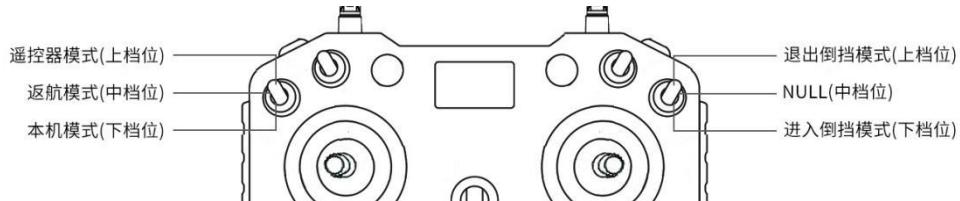
6. 倒档: 在遥控模式下, 倒挡开关拨杆到最下, 进入倒档模式; 倒挡开关拨杆到最上档位可以退出倒档。
