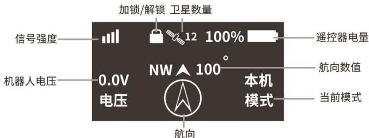
机器人电压说明:42V 满电, 31.5V 低电, 30V 自动关机
